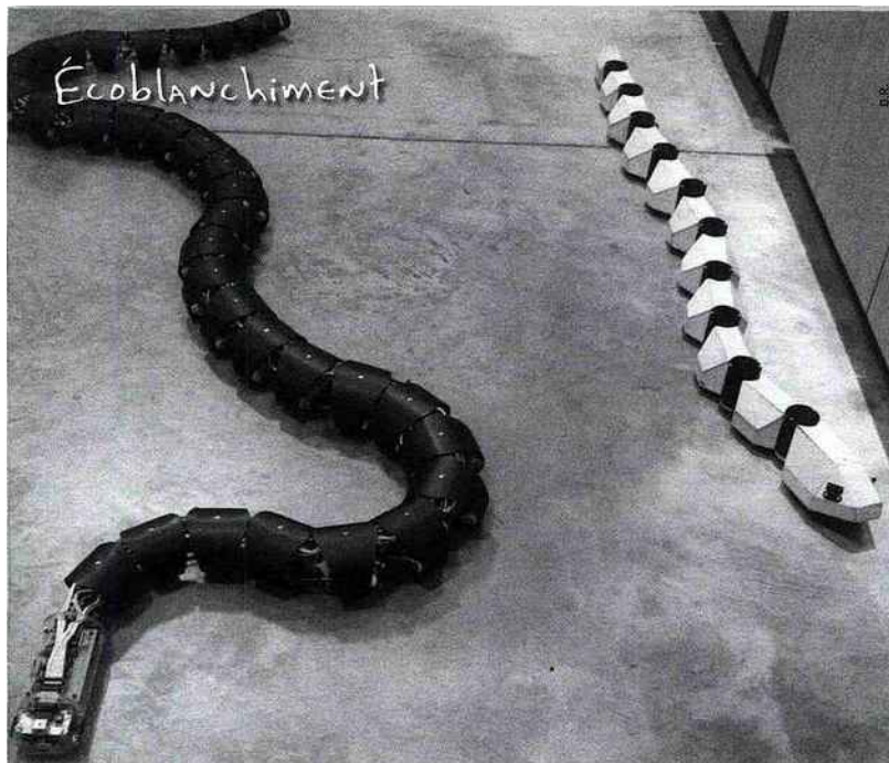
▲ Robot Snake Ce type de robot est utilisé par l'armée israélienne il se faufile partout en renvoyant ce qu'il voit et entend au soldat qui le dirige avec son ordinateur portable
